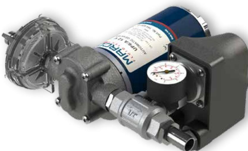
**IT** Elettropompe autoadescenti ad ingranaggi elicoidali in PEEK, corredate di filtro in linea, valvola di non ritorno e pressostato, per impiego come pompe automatiche. Corpo in ottone nichelato, albero in acciaio inossidabile, tenute FKM e o-ring in NBR. Disponibili con vaso ad espansione integrato.
