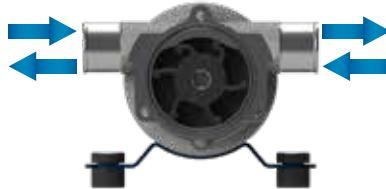
**IT** Elettropompe autoadescenti con girante flessibile in gomma. La girante in gomma garantisce alta portata e permette il passaggio di piccole impurità contenute nelle acque grigie. Disponibili con portate da 28 l/min a 45 l/min e in versioni con interruttore o deviatore integrati. Dotate di portaspazzole interno con filtro antidisturbo EMI, calotta impermeabile e passacavo stagno. Corpo in ottone nichelato, albero in acciaio inossidabile. Tenute in FKM e O-ring in NBR. ISO 8849 e ISO 8846.
