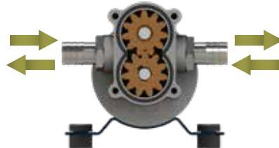
**IT** Elettropompe ad ingranaggi in bronzo per travaso di oli lubrificanti o di liquidi viscosi. Gli ingranaggi elicoidali in bronzo garantiscono pressione costante, cicli di lavoro prolungati, maggiore silenziosità e possono operare anche in mancanza di liquido. Corpo in ottone nichelato, albero in acciaio inossidabile. Tenute in FKM e O-ring in NBR. Disponibili in versioni con interruttore o deviatore integrati, kit con interruttore cavi e pinze per batteria e kit con controllo elettronico.
