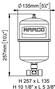
**IT** Vasi ad espansione in acciaio inox per pompe automatiche. Attacco in acciaio inox. Membrana in gomma per liquidi alimentari.
